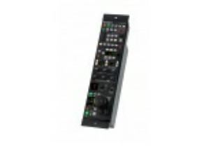
RCP-3100 Panel zdalnego sterowania z joystickiem przeznaczony do kamer z serii HDC/HSC/HXC. <br>Możliwość montażu 5 modułów w 19-calowej szafie EIA.
